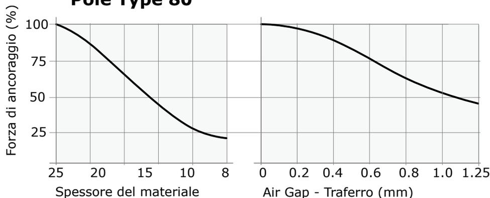
Il Polo Tipo 80 è progettato per sollevare lastre a partire da 8 mm di spessore con superficie piana. La forza nominale del Polo Tipo 80 è raggiunta con air gap di 0.4 mm. Con air gap 0, il Polo Tipo 80 raggiunge una forza di ancoraggio di 9 kN.
